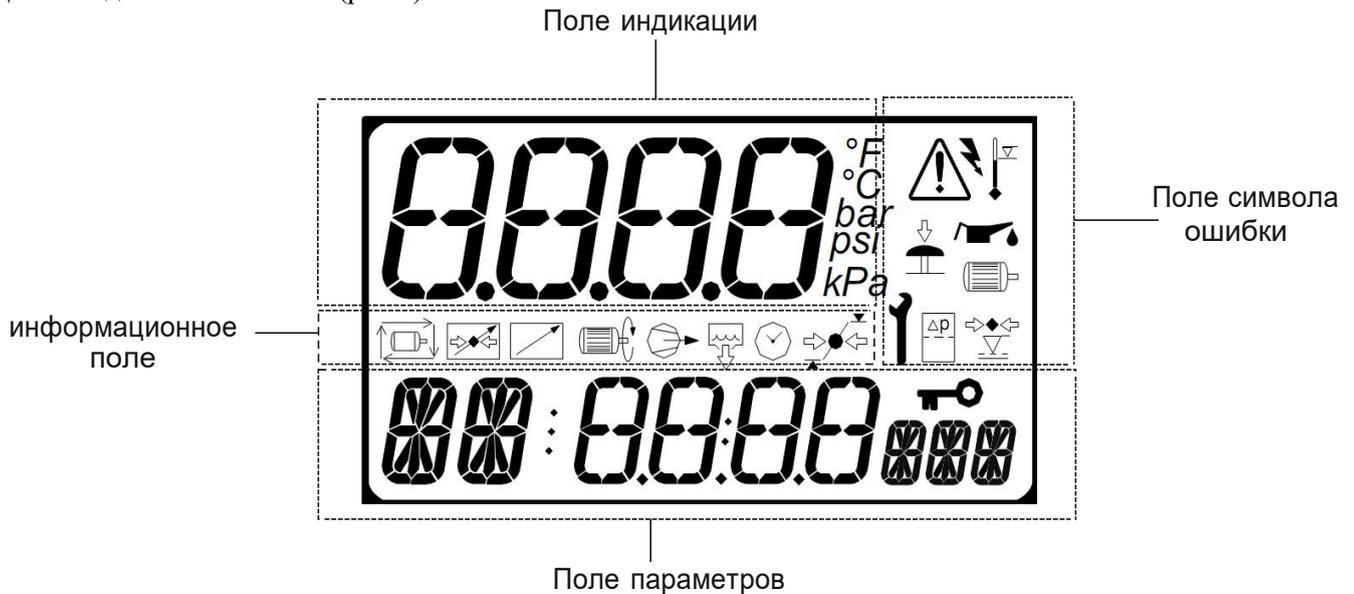
Рис. 1. Дисплей контроллера
