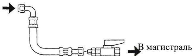
Перед пуском отсекающий кран обязательно должен быть открытым. Трубопроводы следует укладывать с уклоном 0,005 в сторону линейных влагоотделителей.
