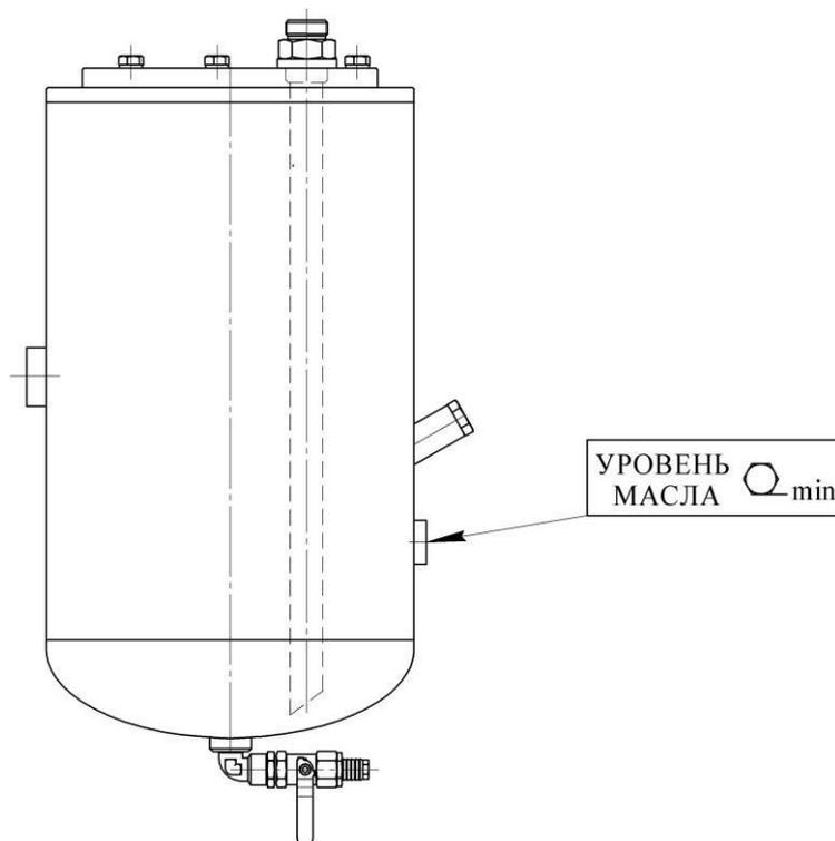
Примечание: Оптимальная температура окружающей среды для контроля уровня масла равна  $20 \pm 5^\circ\text{C}$ .
