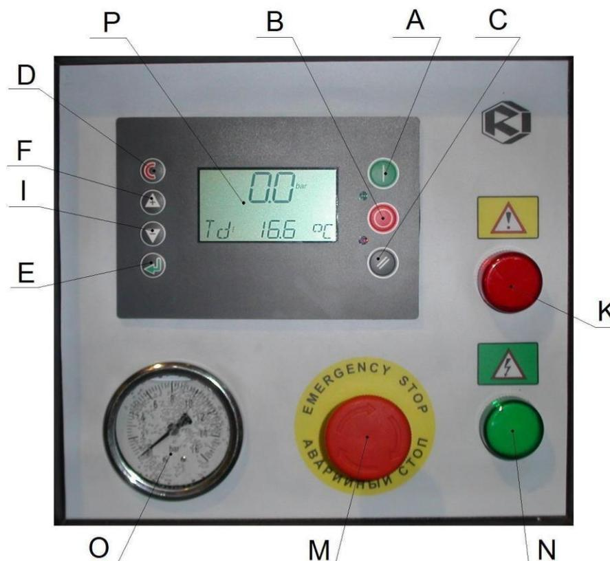
**A** - кнопка "ПУСК" – вход в состояние ЗАПУСКА.
