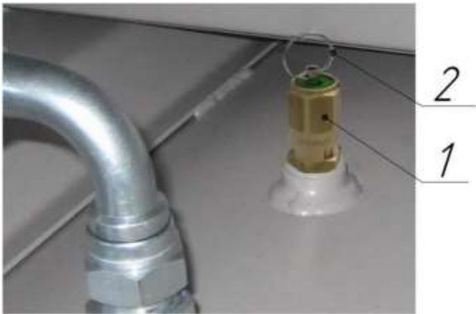
Рисунок 9 – Клапан предохранительный пружинного типа
