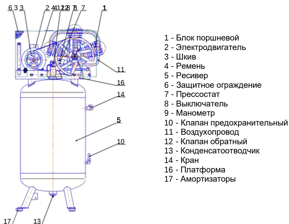
Рисунок 10 - Общий вид компрессора СБ4/Φ-270.LB40B
